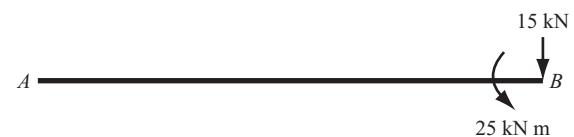
(d) Equivalent force – Moment at B
